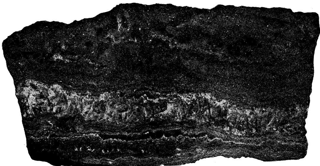
Fotografía número 2. - Veta "Blanca." Nivel + 125. Labor de Brígido López. (Estructura en bandas paralelas.)
