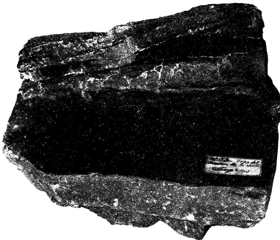
Fotografía número 2.—Pizarras arcillosas negras muy plegadas, cortadas por el Socavón de la mina "La Lucha." (Del tope del Socavón.)
